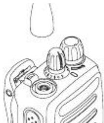
Выключив радиостанцию, установите антенну в соответствующее гнездо и поверните по часовой стрелке.
